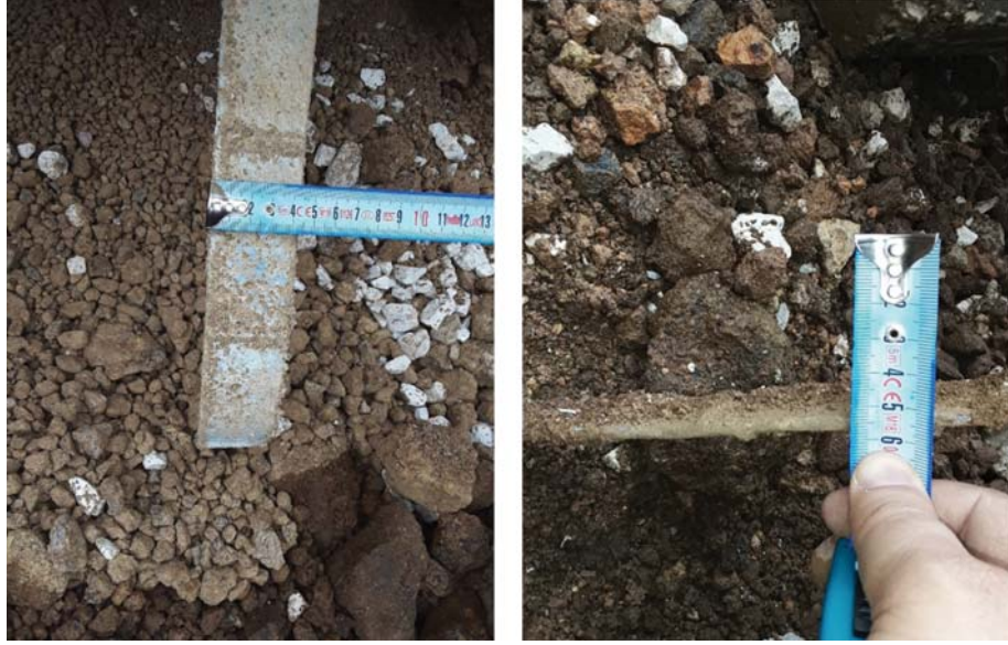
Şekil 5 - Zemin donatı şeritleri genişliği ve et kalınlığı
