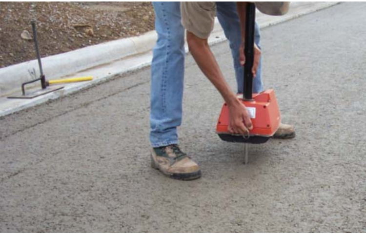
Şekil 8 - Yoğunluk ölçümünde nükleer cihazların kullanımı [1]
